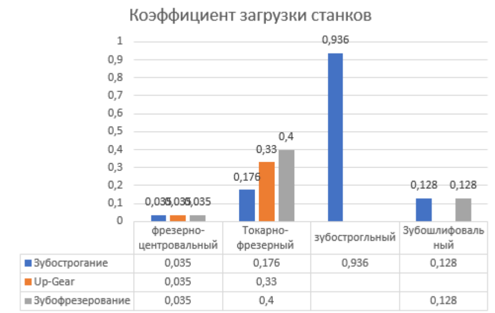
Рисунок 6. Диаграмма коэффициента загрузки станков при разных видах обработки
